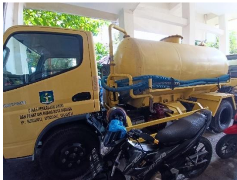
Gambar 5. 15 Contoh Truk Penyedot Tinja
