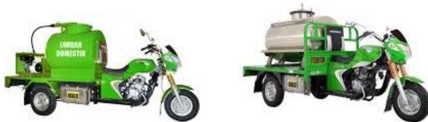
Gambar 5. 16 Contoh Motor Penyedot Tinja
